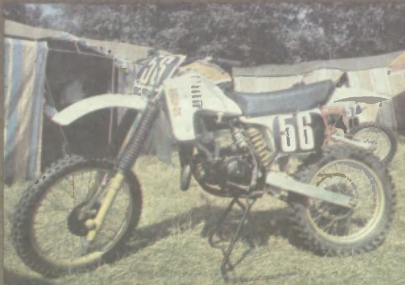
«Восток—3.246» (СССР). Устройство для изменения на ходу сечения выпускной трубы. Подвеска заднего колеса с прогрессивной характеристикой. Мощность — 30 л. с. при 10 200 об/мин. Ход колес: 305 и 305 мм. База — 1437 мм. Масса — 99,5 кг.
